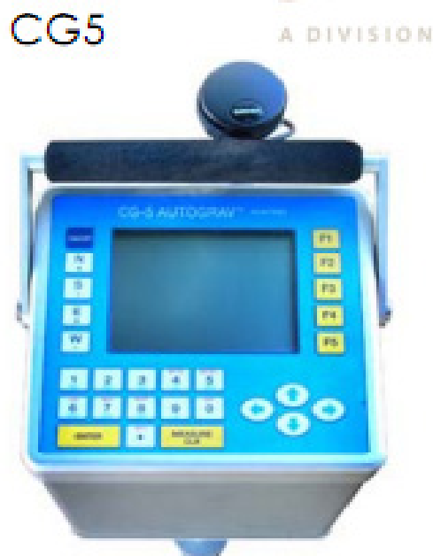
Рис. 11. Внешний вид гравиметра Scintrex CG5
